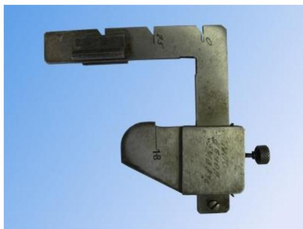
**Рис. Шаблон для замера верт. подреза гребня**
