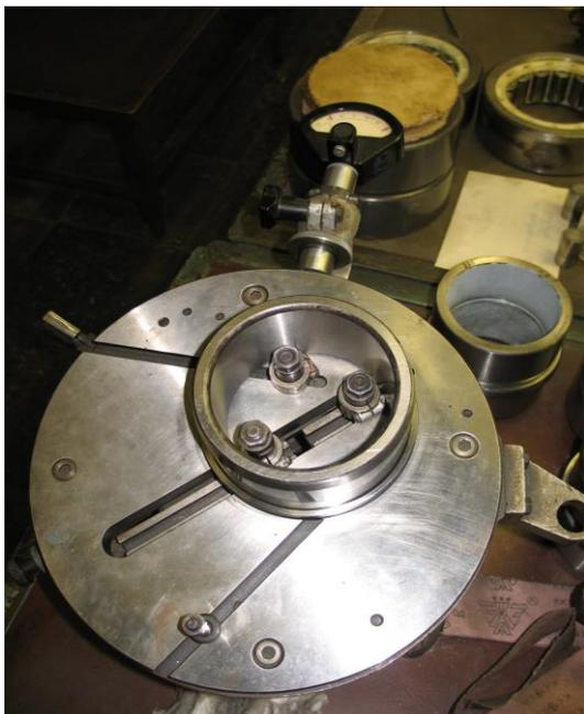
**Аппарат для контроля диаметра подшипников**
